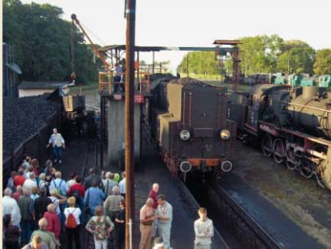
Parowóz Pt47 – 112 (prod. HCP Poznań, 1949 r.) podczas nawęglania. Tender mieści 10 t węgla. Z prawej strony widoczny parowóz Ty1 – 76, produkcji niemieckiej z 1919 r.
