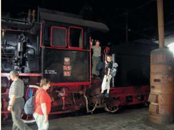
Parowóz produkcji niemieckiej z 1921 r. Tr5 – 65 w hali postojowej. Z prawej strony widoczny żeliwny piec typu Hohenzollern do ogrzewania hali. Wydajność cieplną pieca można regulować, zmieniając liczbę kręgów.
