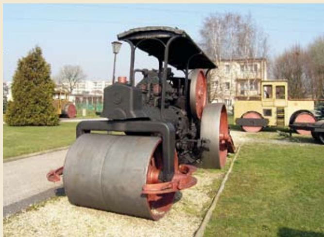
Parowy walec drogowy produkcji H. Cegielski – Poznań z 1929 roku. Na drugim planie spalinowy wibrowalec z 1978 roku wyprodukowany w NRD.
